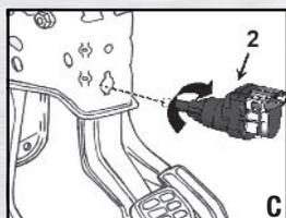
La position du Contacteur quand il est monté est celle du "Contacteur activé". C'est dans cette position que l'on peut vérifier son fonctionnement.
