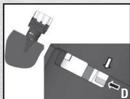
**D - IMPORTANT** : Au moment où l'on tourne le contacteur dans sa position correcte, on doit entendre un déclic. Cette opération a pour effet de verrouiller le réglage du poussoir. Lorsque le contacteur de feux stop est correctement monté, alors l'axe de butée interne (flèche blanche) du contacteur de feux stop est bien en place au bout de la rainure de l'enveloppe externe.
