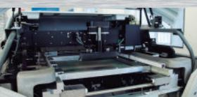
**Comment ?** Système d'impression pour substrats rigides allant jusqu'à 8 x 8 pouces, assisté par vision artificielle. Système d'impression pour substrats rigides de jusqu'à 2 x 2 pouces.
